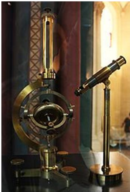
Гироскоп Фуко (построил Дюмолен-Фромент, 1852)
